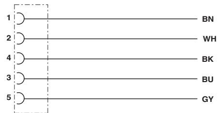
Kontaktbelegung des M12-Stecker und der M12-Buchse
