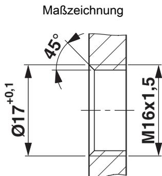
Gehäuseausschnitt für M16-Befestigungsgewinde, Montagewand mit Gewinde
