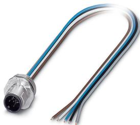
Sensor-/Aktor-Einbaustecker, 5-polig, M12-SPEEDCON, A-kodiert, Vorderwand-/Schraubmontage mit M16-Gewinde, mit 0,5 m TPE-Litze, 5 x 0,34 mm<sup>2</sup>
