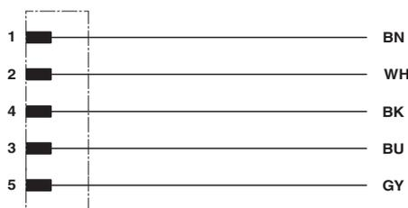
Kontaktbelegung des M12-Stecker
