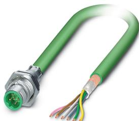
Bussystem-Einbaustecker, INTERBUS, 5-polig, M12, geschirmt, B-kodiert, Hinterwand-/Schraubmontage mit M16-Gewinde, mit 1 m Buskabel
