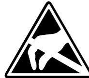
Das Symbol befindet sich auf Modulen, Baugruppen, Baugruppenträgern oder auf Verpackungen und weist so auf elektrostatisch gefährdete Komponenten hin.
