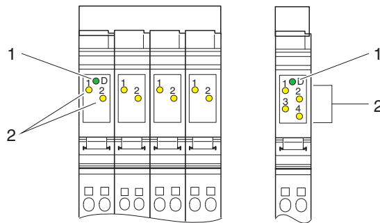
Bild 9-2 Anzeigen auf Ein-/Ausgabeklemmen
