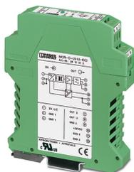
MCR-3-Wege-Trennverstärker, mit konfigurierbarem Ein-/Ausgang, zur galvanischen Trennung von Analogsignalen, vorkonfiguriert. Zulässige Signalkombinationen entnehmen Sie bitte dem Datenblatt. Ersatzartikel: 2811284 MACX MCR-UI-UI.
