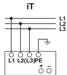
Der Anschluss für 2x/3x 400 V AC ... 500 V AC erfolgt über die Schraubverbindungen L1, L2, L3 und PE.
