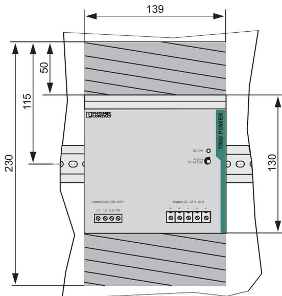
Einbaulage: Einbautiefe 190 mm (+ Tragschiene)
