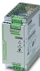
Primär getaktete Stromversorgung, QUINT POWER, Schraubanschluss, Tragschienenmontage, SFB Technology (Selective Fuse Breaking), Eingang: 1-phasig, Ausgang: 24 V DC / 10 A
