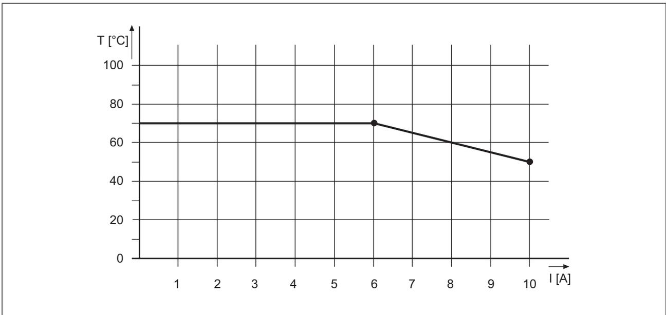
PSSu E F PS-T: Derating-Diagramm der Einspeisung für Module Supply: Zulässige Umgebungstemperatur T in Abhängigkeit vom Laststrom I
