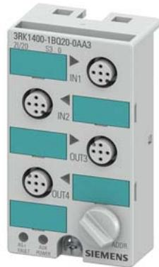
AS-i Kompaktmodul K45 digital 2DI/2DQ, IP67 2 x Eingang, maximal 200 mA 2 x Ausgang, 2 A DC 24 V maxima 3 A für alle Ausgänge 4 x M12-Buchse Montageplatte 3RK1901-2EA00 oder 3RK1901-2DA00 ist separat zu bestellen
