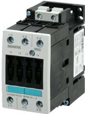
Leistungsschütz, AC-3 32 A, 15 kW / 400 V AC 110 V, 50/60 Hz 3-polig, Baugröße S2, Schraubanschluss !!! Auslaufprodukt !!! Nachfolger ist SIRIUS 3RT2 Präferierte Nachfolgertyp ist >>3RT2027-1AG20<<
