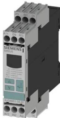
Digitales Überwachungsrelais Drehzahlüberwachung von 0.1 bis 2200 U/min Über- und Unterschreitung AC/DC 24 bis 240 V DC und AC 50 bis 60 Hz Anlaufverzögerung 1 bis 900 s Auslöseverzögerung 0,1 bis 99,9 s Hysterese 0.1 bis 99 U/min 1 Wechsler mit oder ohne Fehlerspeicher Schraubanschluss Nachfolgeprodukt für 3UG3051
