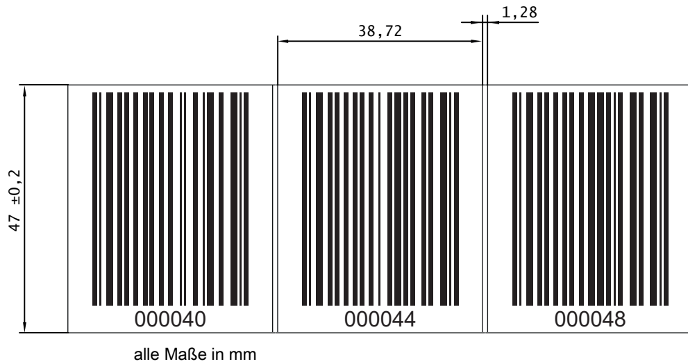
Bild 13.13: Maßzeichnung Barcodeband BCB im 40 mm Raster
