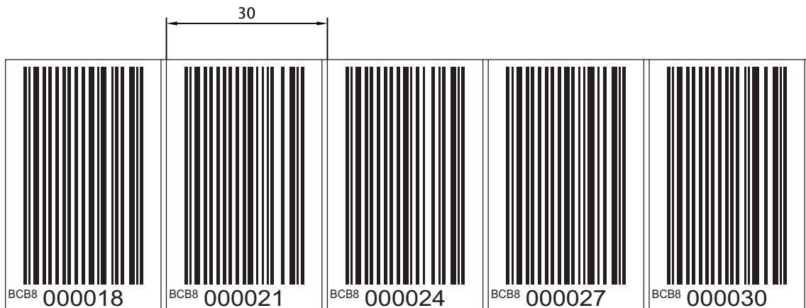
Bild 11.2: Überprüfen des Druckergebnisses BCB8-Reparaturkit (30 mm Raster)
