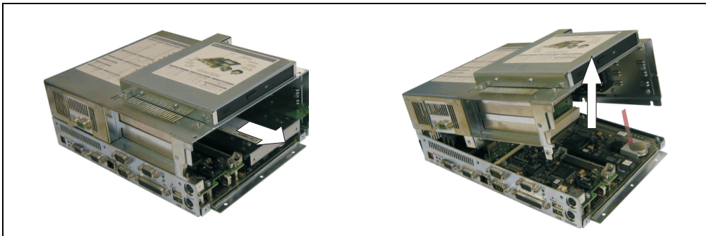
Abbildung 70: Abnehmen der Abdeckung und der Buseinheit
