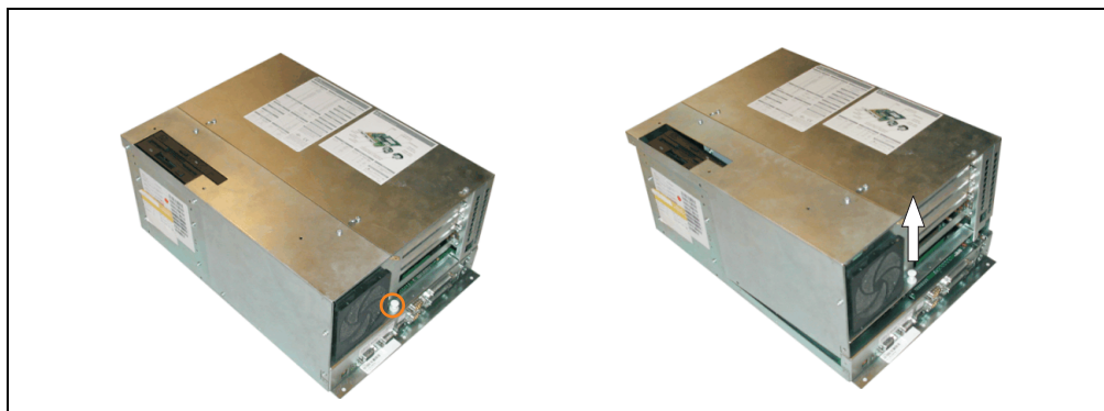
Abbildung 72: Entriegeln des Sicherheitszapfens und Buseinheit abnehmen
