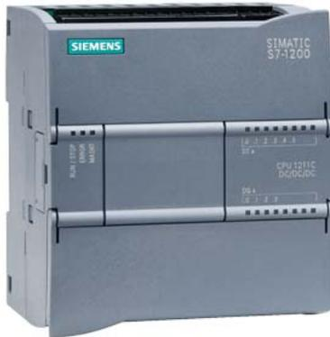
\*\*\*Ersatzteil\*\*\* SIMATIC S7-1200, CPU 1211C, Kompakt-CPU, DC/DC/DC, onboard I/O: 6 DI DC 24V; 4 DO 24V DC; 2 AI 0-10V DC, Stromversorgung: DC 20,4-28,8V DC, Programm-/Datenspeicher 25 KB
