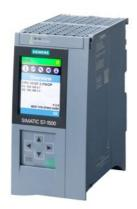
SIMATIC S7-1500F, CPU 1516F-3 PN/DP, Zentralbaugruppe mit Arbeitsspeicher 1,5MByte für Programm und 5MByte für Daten, 1. Schnittstelle: PROFINET IRT mit 2 Port Switch, 2. Schnittstelle: PROFINET RT, 3. Schnittstelle: PROFIBUS, 10 ns Bit-Performance, SIMATIC Memory Card notwendig
