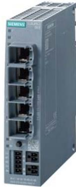
SCALANCE S615 LAN-Router; zum Schutz von Geräten/Netzen in der Automatisierungstechnik und zur Sicherung der industriellen Kommunikation mittels VPN und Firewall; Weitere Funktionen: Adressumsetzung (NAT/NAPT), Anbindung an SINEMA RC, 5-Port Switch, 1x dig. Eingang, 1x Digitalausgang
