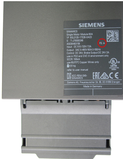
Bild 7-2 Typenschild am Motor Module ("FS" im roten Kreis)
