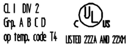
Abbildung 19: Textdetail - Beispielbedruckung der Busklemmen gemäß NEC 500
