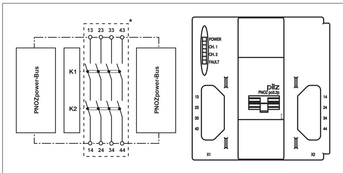
\*Sichere Trennung zum nicht markierten Bereich nach EN 60947-1, 6 kV, Basisisolierung der Relaiskontakte zueinander.
