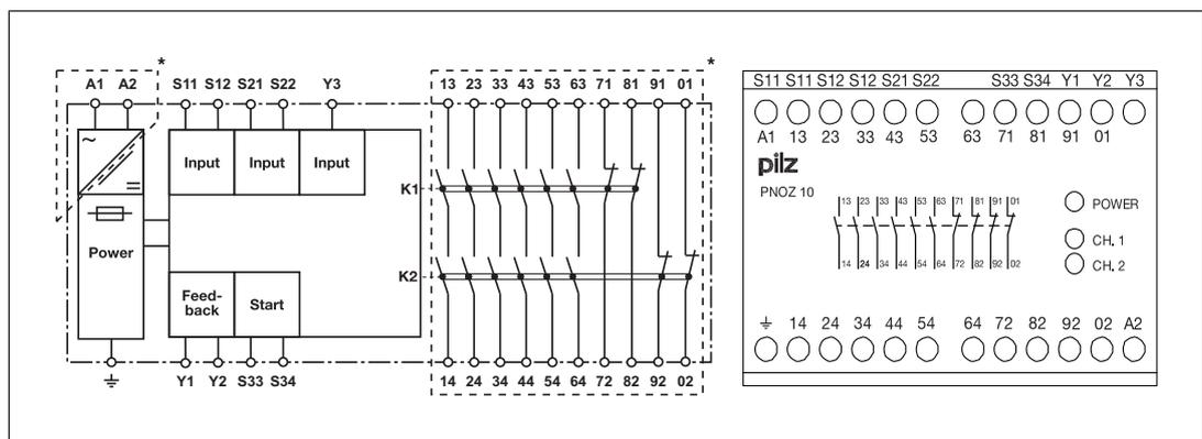
\*Isolation zum nicht markierten Bereich und der Relaiskontakte zueinander: Basisisolation (Überspannungskategorie III), sichere Trennung (Überspannungskategorie II)
