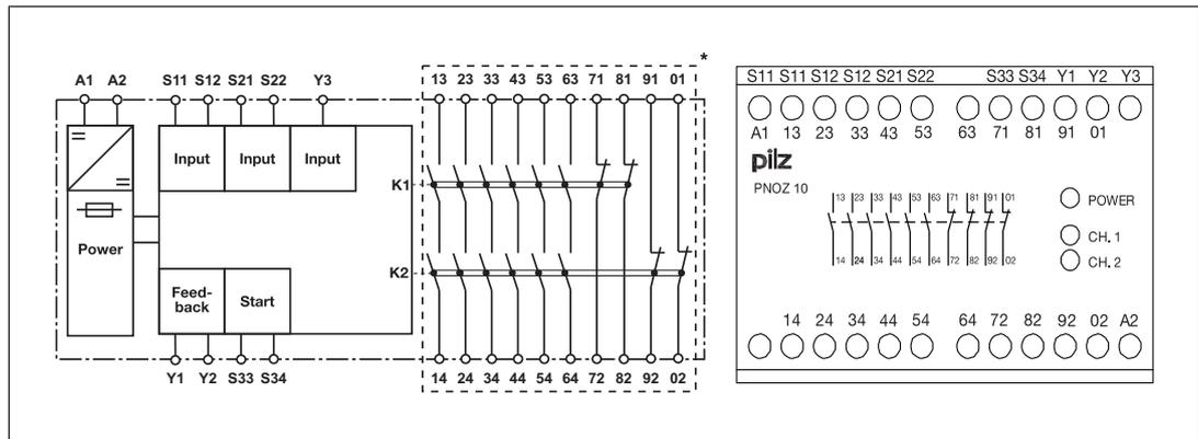
\*Isolation zum nicht markierten Bereich und der Relaiskontakte zueinander: Basisisolierung (Überspannungskategorie III), sichere Trennung (Überspannungskategorie II)
