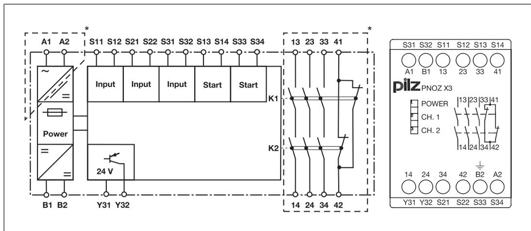
\*Isolation zum nicht markierten Bereich und der Relaiskontakte zueinander: Basisisolierung (Überspannungskategorie III), sichere Trennung (Überspannungskategorie II)
