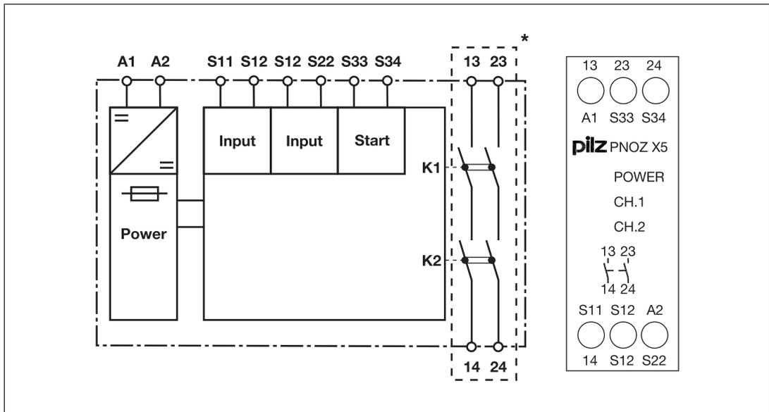
\*Isolation zum nicht markierten Bereich und der Relaiskontakte zueinander: Basisisolierung (Überspannungskategorie III), sichere Trennung (Überspannungskategorie II)
