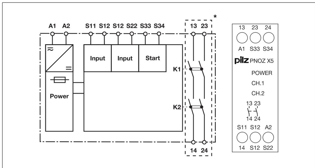
\*Isolation zum nicht markierten Bereich und der Relaiskontakte zueinander: Basisisolation (Überspannungskategorie III), sichere Trennung (Überspannungskategorie II)
