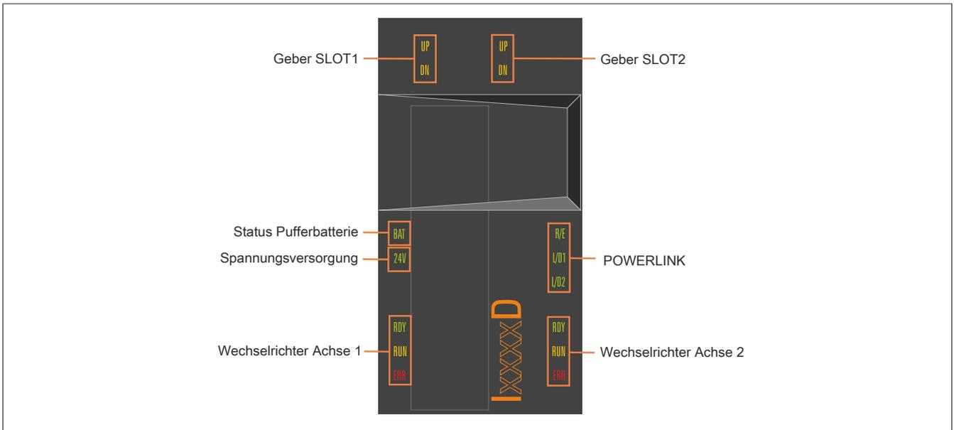
Abbildung 3: Anzeigegruppen Wechselrichtermodule 8BVI (Zweiachsmodul)
