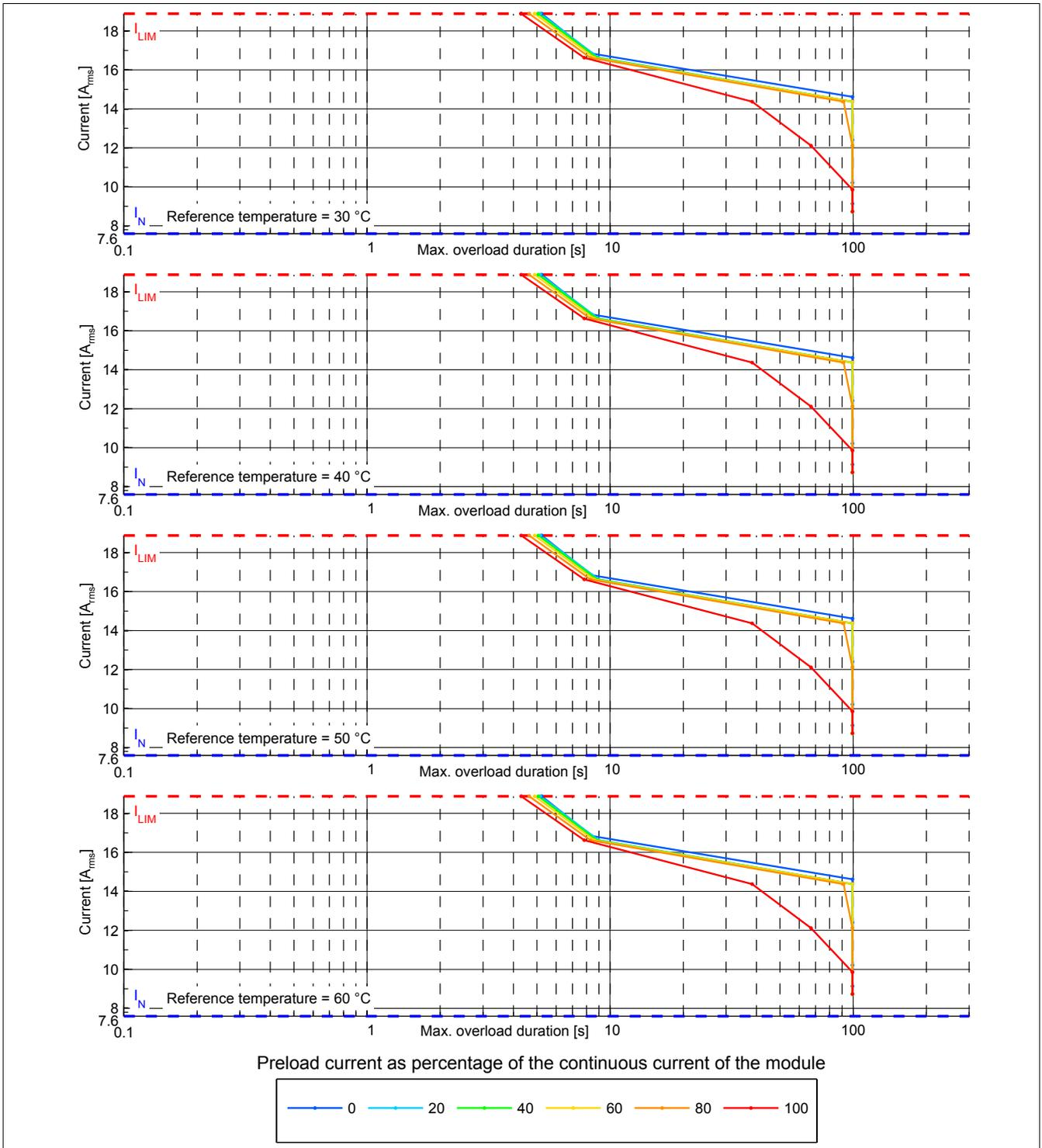
Abbildung 1: Überlast-Charakteristik 8BVI0055HCDx.000-1, Überlastreaktion - WARNING
