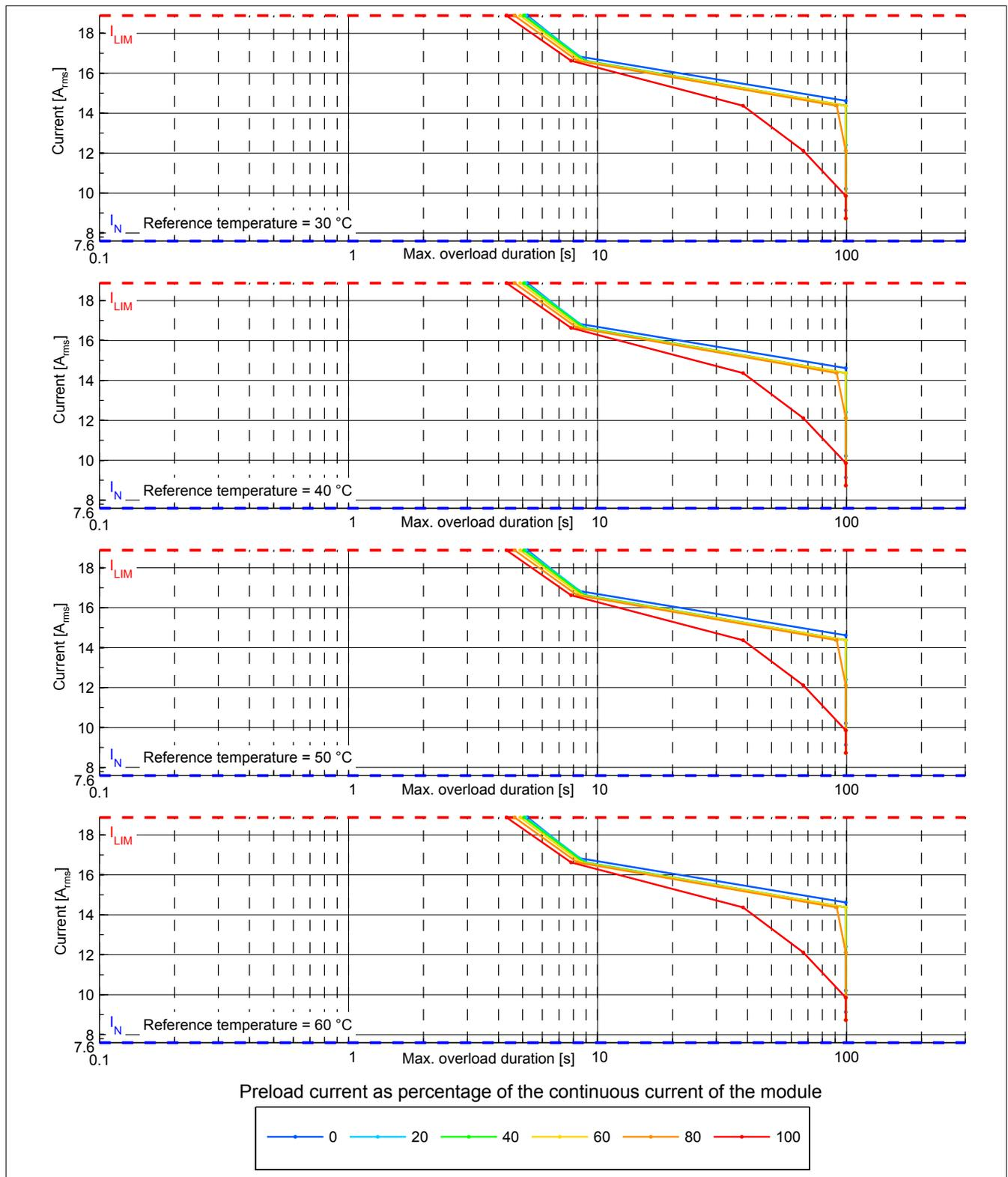
Abbildung 2: Überlast-Charakteristik 8BVI0055HCDx.000-1, Überlastreaktion - ERROR + STOP
