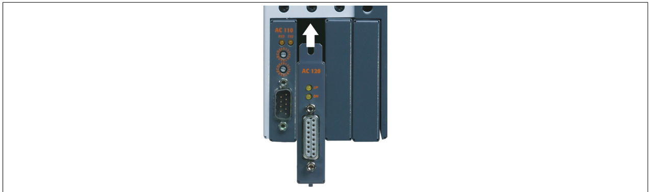
Abbildung 60: Einbau von ACOPOS Einsteckmodulen
