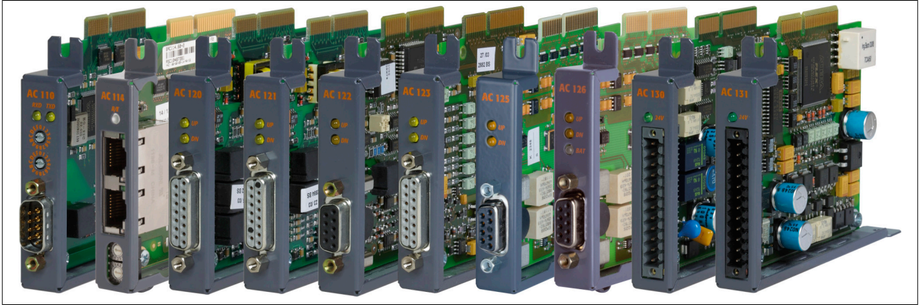
Abbildung 2: Einsteckmodule machen eine optimale applikations-spezifische Konfiguration der ACOPOS Servoverstärker möglich
