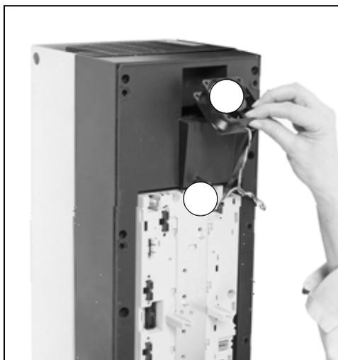
■ Austausch des Hauptlüfters bei den Baugrößen R6 bis R8
