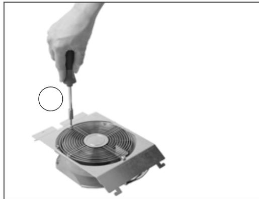
■ **Austausch des Zusatzlüfters bei den Baugrößen R6 bis R9**
