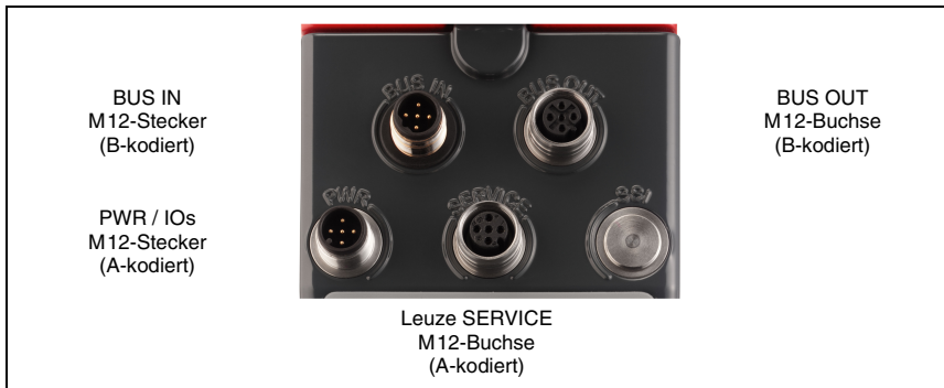
Bild 7.1: Anschlüsse des AMS 384 i
