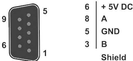
Abb. 20: Pinbelegung der PROFIBUS D-Sub Buchse
