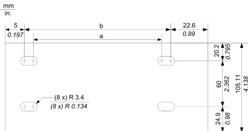
**HINWEIS:** Sie können Schrauben des Typs M4, M5, M6 oder UNC #6 in den Befestigungslöchern verwenden.
