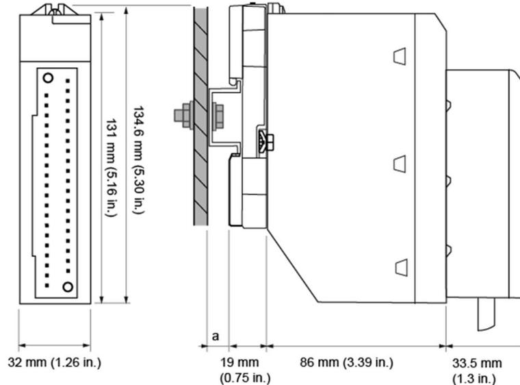
**a** Tiefe der DIN-Schiene: Der Wert ist von dem in Ihrer Plattform verwendeten DIN-Schientyp abhängig. Siehe *Montage der Racks* (siehe Seite 39).
