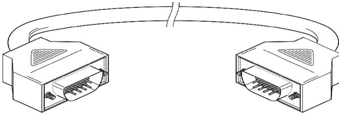
Die BMXXBC•••K-Kabel verwenden Verbindungsstecker mit 45°-Winkel:
