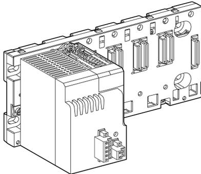
**HINWEIS:** Aufgrund ihres spezifischen Designs können die Spannungsversorgungsmodule nur in den speziell dafür vorgesehenen Steckplätzen eingesetzt werden.
