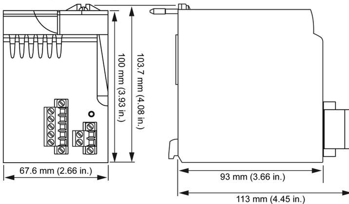
Die nachstehende Abbildung zeigt die Abmessungen eines redundanten Spannungsversorgungsmoduls:
