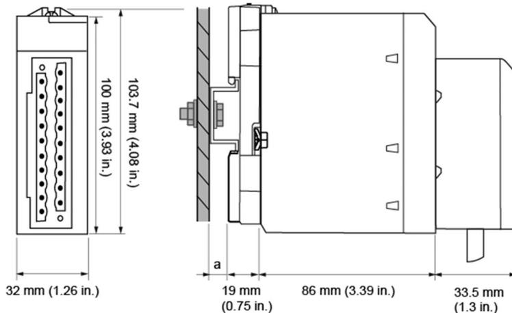
a Tiefe der DIN-Schiene: Der Wert ist von dem in Ihrer Plattform verwendeten DIN-Schienentyp abhängig.
