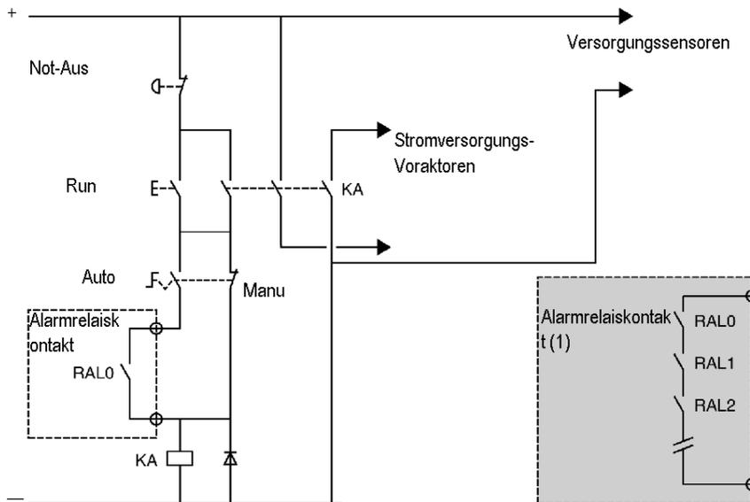
KA: Am Alarmrelais gesteuertes Schütz (1) der Versorgungseinheit im AUTO-Betrieb.
