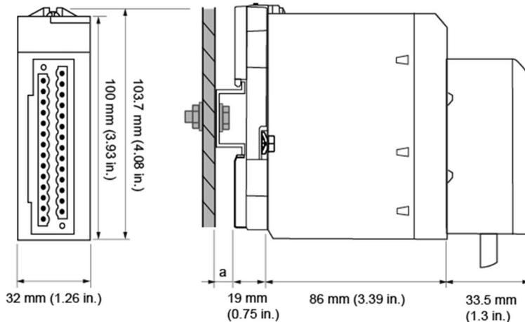
a Tiefe der DIN-Schiene: Der Wert ist von dem in Ihrer Plattform verwendeten DIN-Schientyp abhängig.
