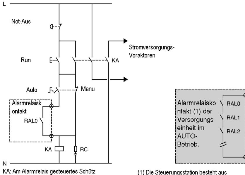
(1) Die Steuerungsstation besteht aus mehreren Racks: Kontakte "Alarmrelais" (RAL0, RAL1, RAL2,...) werden in Reihe geschaltet.
