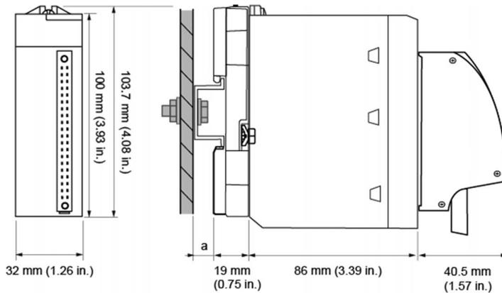
a Tiefe der DIN-Schiene: Der Wert ist von dem in Ihrer Plattform verwendeten DIN-Schientyp abhängig.
