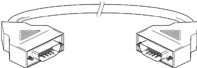
**HINWEIS:** Um zwei Rack-Erweiterungsmodule in einem Gehäuse anzuschließen, wird die Verwendung von BMX XBC •••K-Kabeln mit 45-Grad-Verbindern empfohlen.
