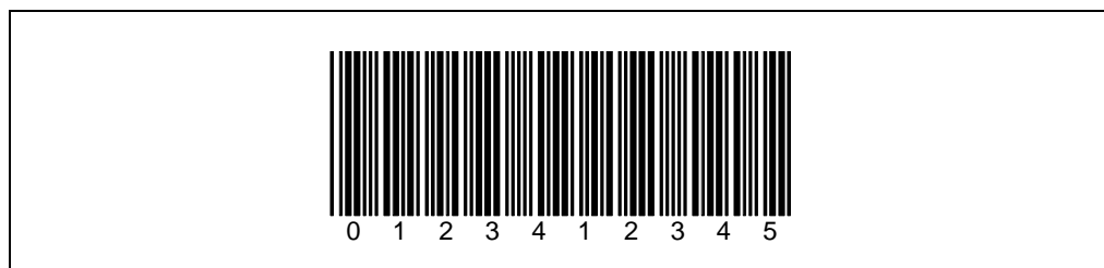
Abb. 6-1: Barcode-Muster (Code 39; Modulbreite 0,35 mm; Druckverhältnis 2:1)
