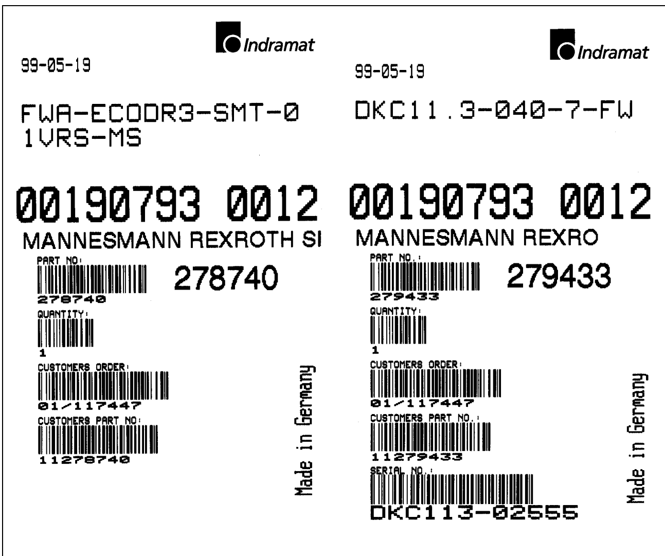
Abb. 13-1: Aufbau der Barcode-Aufkleber auf der Verpackung
