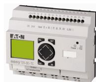
Steuerrelais, 24VDC, 12DI(4AI), 8DO-Trans, Display, Uhr, erweiterbar
