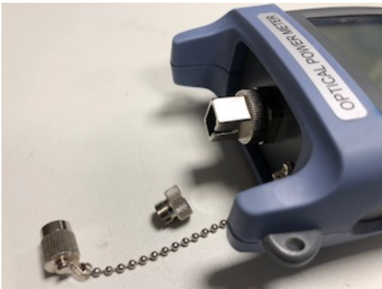
OPM mit aufgeschraubtem SC Adapter
