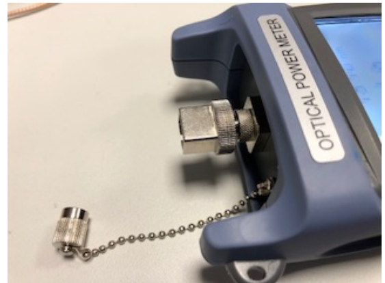
OPM mit aufgeschraubtem FC u. SC Adapter - FALSCH
