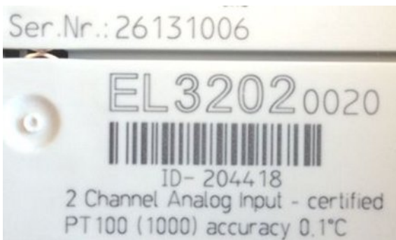
Abb. 3: EL3202-0020 mit Seriennummer/ Chargennummer 26131006 und eindeutiger ID-Nummer 204418
