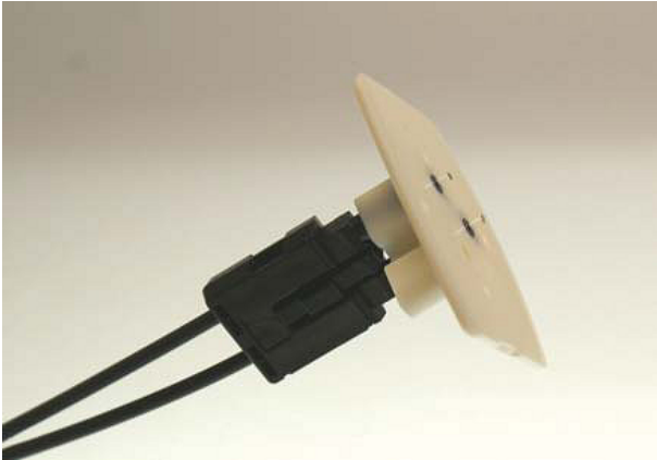
Abb. 38: Schleiflehre mit herausragenden Faserenden
