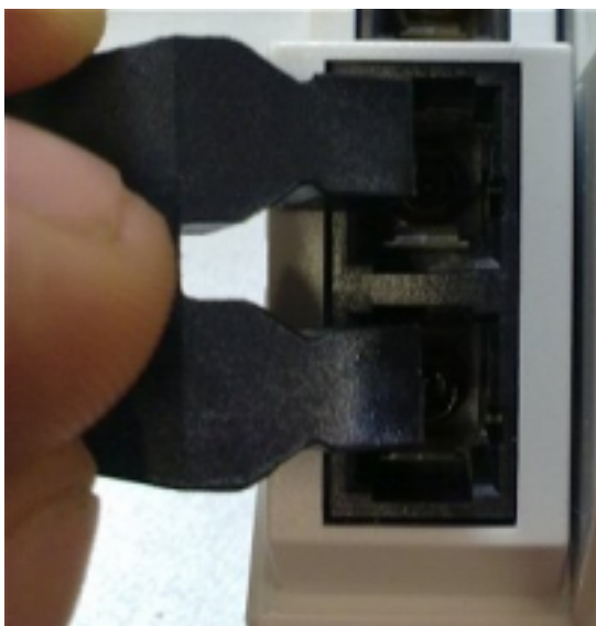
Abbildung: Blindstopfen in nicht verwendeten Anschlussbuchsen
