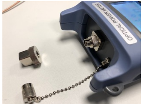
OPM mit aufgeschraubtem FC Adapter
