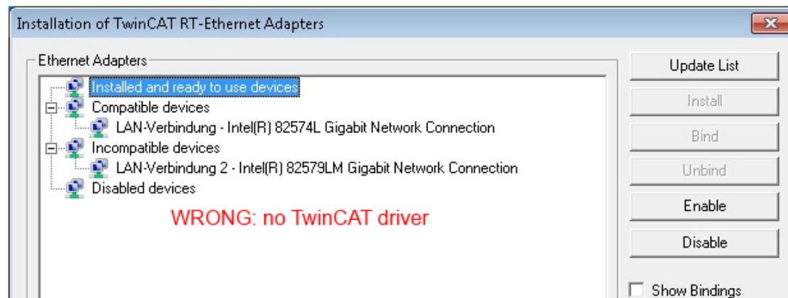
Abb. 137: Fehlerhafte Treiber-Einstellungen des Ethernet Ports
