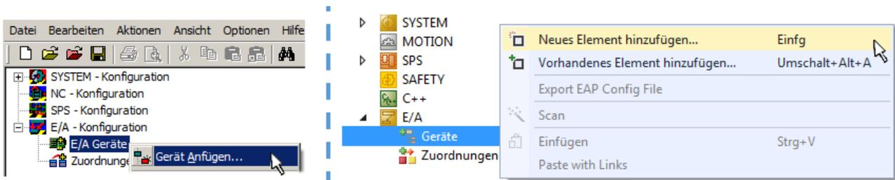
Abb. 147: Anfügen eines EtherCAT Device: links TwinCAT 2; rechts TwinCAT 3
