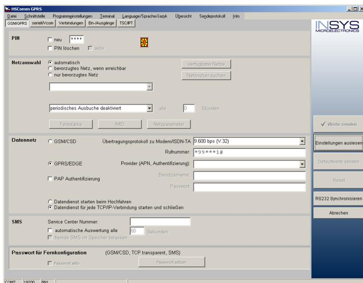
Die HSComm GPRS prüft beim Start das angeschlossene Gerät. Standardmäßig sind nur die Einstellungen wählbar, die im erkannten Gerät implementiert sind.
