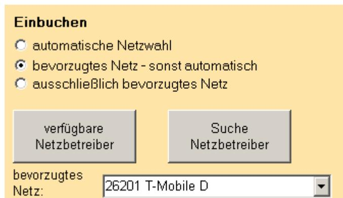
Die aktuellen Einstellungen an das INSYS GPRS 5.1 serial übertragen. Anschließend muss am Gerät ein Reset durchgeführt. Mit dem Auslesen der aktuellen Einstellungen ist das INSYS GPRS 5.1 serial eingebucht.
