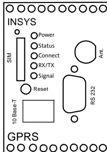
Zur Betriebsanzeige besitzt das INSYS GPRS 5.1 serial fünf LEDs:
