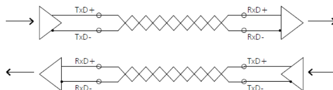
Abb. 4: Anschluss bei RS422 Übertragung
