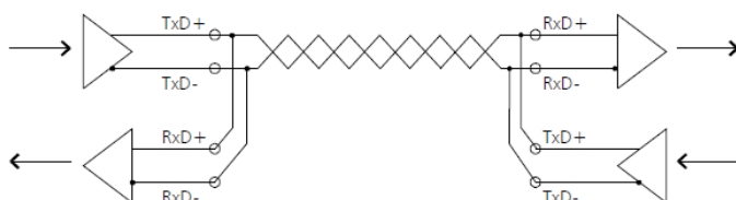
Abb. 3: Anschluss bei RS485-Übertragung
