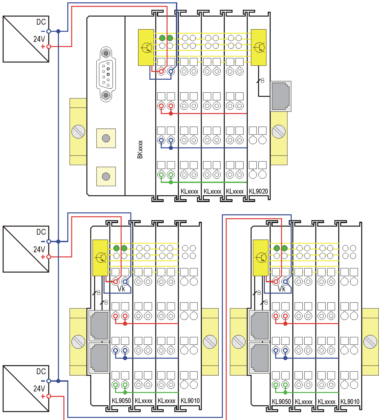
Abb. 15: KL9020, KL9050 - Anschluss der Spannungsversorgung
