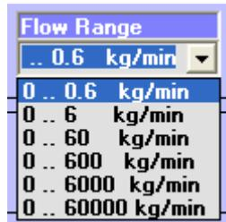
Der maximale Messbereichsendwert für die Durchflussmessung ist hier anwählbar. Der Gebermessbereich muss innerhalb des angezeigten Messbereiches (RANGE) liegen, andernfalls wird im Betrieb Messbereichsüberschreitung angezeigt (die grüne LED für die Betriebsbereitschaft erlischt und signalisiert dadurch "ERROR").
