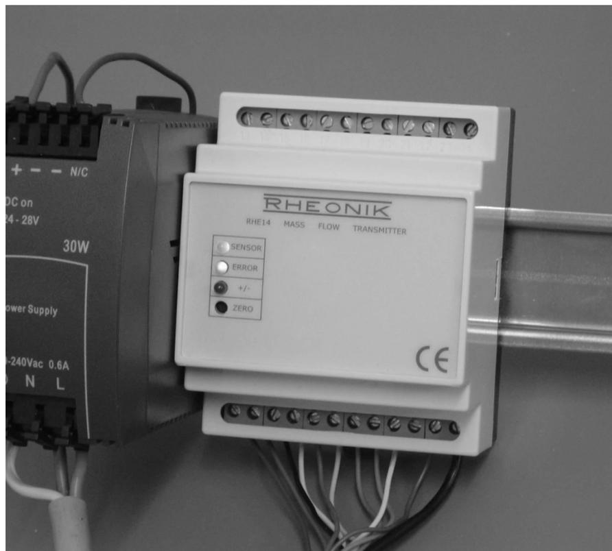
Das Umformergehäuseoberteil lässt sich abnehmen wenn die Rasthaken rechts und links am Gehäuseunterteil vorsichtig mit einem Schraubendreher nach innen gedrückt werden. Beim Wiederaufsetzen ist zu beachten, dass der Kopf des Drucktasters auf der oberen Umformerplatine richtig in der Deckelbohrung zentriert wird, so dass eine Betätigung durch den Deckel ausgeschlossen wird.
