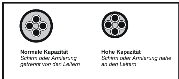
Abbildung 4-11 Einfluss der Kabelkonstruktion auf die Kapazität
