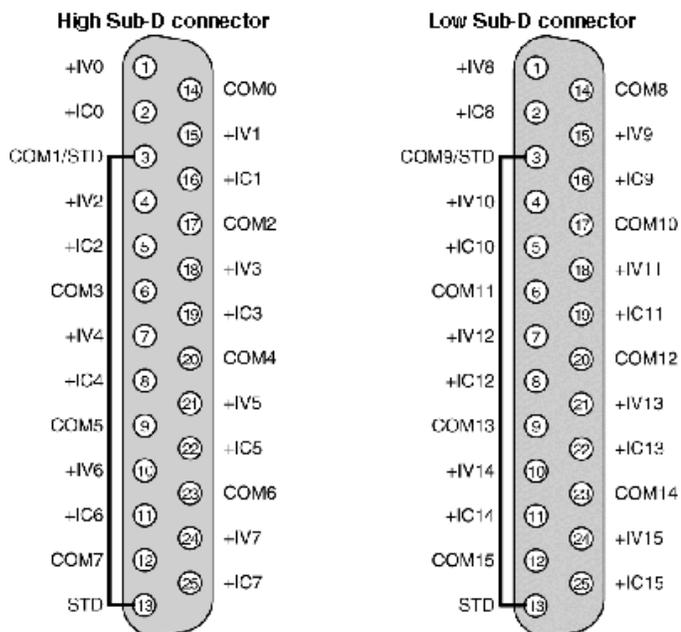
+IVx +-Pol-Spannungseingang von Kanal x
