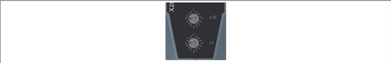
Mittels der beiden Nummernschalter wird die Knotennummer des POWERLINK-Knotens eingestellt.
