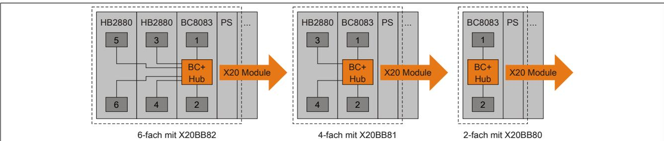
Abbildung 1: Nummerierung der Hub-Schnittstellen
