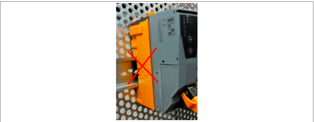
Abbildung 13: X20 System - Abschlussplatten entfernen
