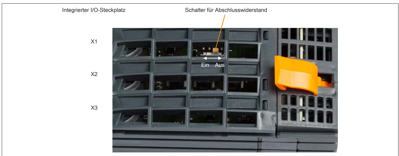
Abbildung 100: Schalterstellungen für den CAN-Bus-Abschlusswiderstand
