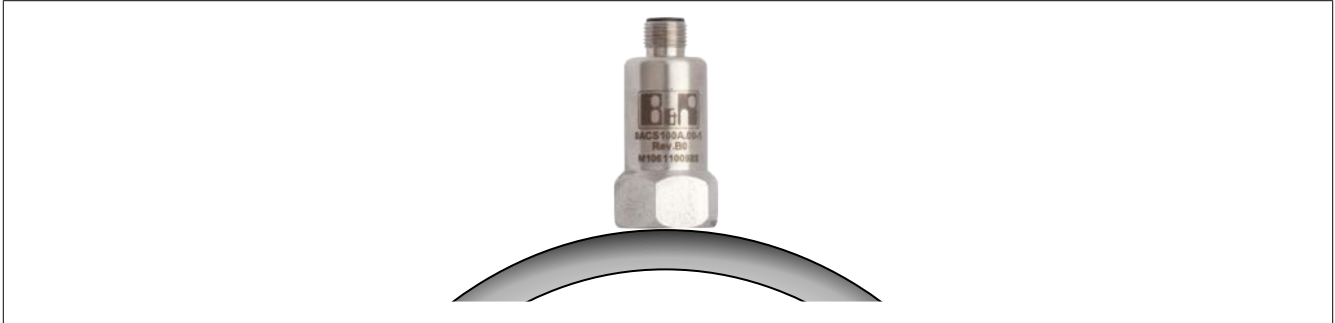
Abbildung 271: Temperaturverformung eines Maschinenteils (Verformung übertrieben dargestellt)
