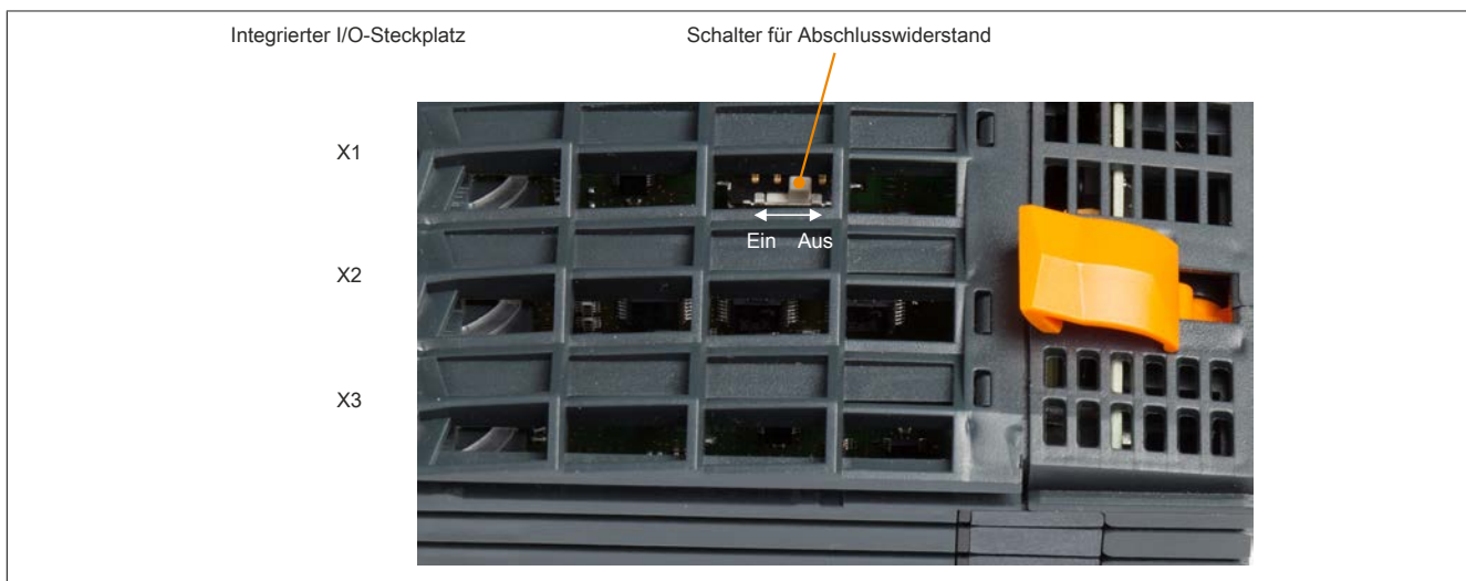
Abbildung 177: Schalterstellungen für den CAN-Bus-Abschlusswiderstand
