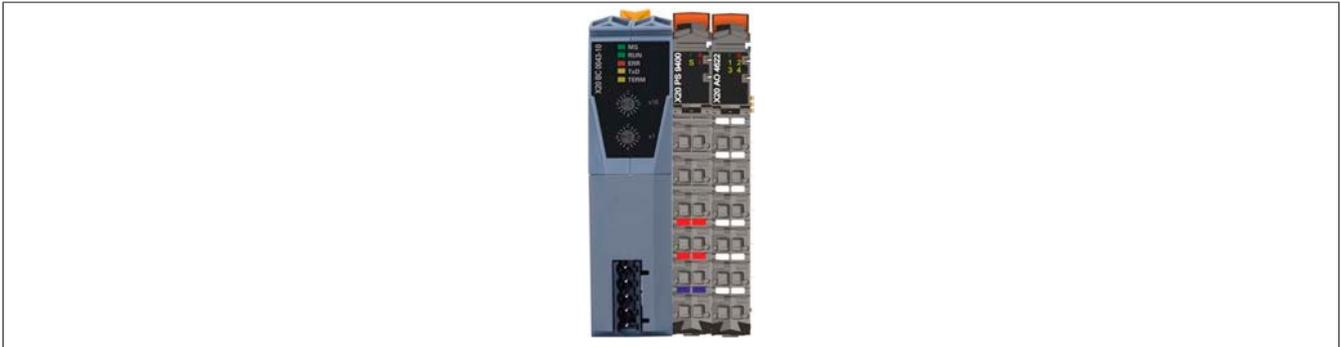
Um den Bus Controller X20BC0043-10 zu konfigurieren, muss sich dieser im Zustand PREOPERATIONAL befinden (LED "RUN" blinkt).
